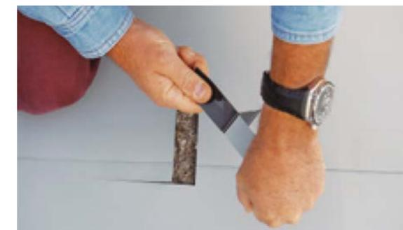
FIG.17. Prueba de Desprendimiento TPO
